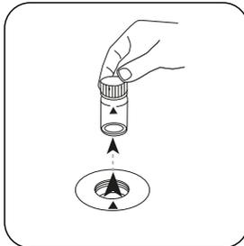
Prelevare la cuvetta dal vano di misurazione.
